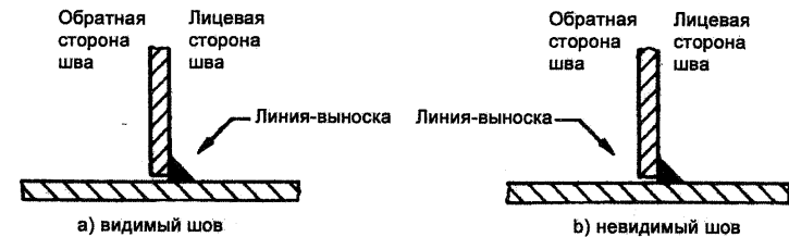
Рисунок 2 – Тавровые соединения с одним угловым швом
